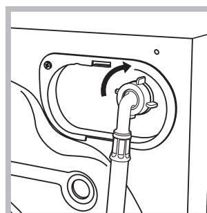
2. Raccorder le tuyau d'arrivée de l'eau au lavante-séchante en le vissant à la prise d'eau prévue, dans la partie arrière en haut à droite (*voir figure*).
